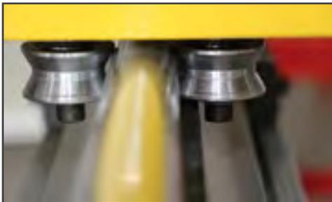
Riel y guía lineal extra reforzada, con diseño en Doble V, para mejorar la calidad, rapidez y precisión en su desplazamiento.
