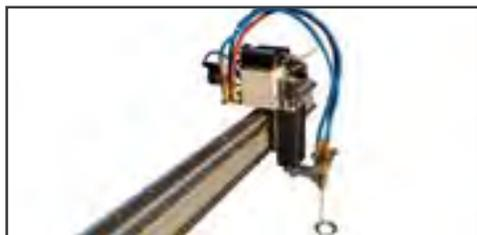
Incluye Sensor de Altura (THC) Arcbro, para corte en estaciones de Oxicorte y Plasma.
