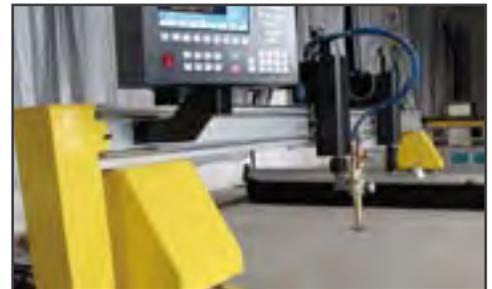
CNC de Alta Definición con sensor de altura (THC).
