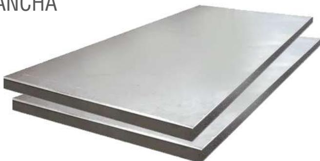
Acero inoxidable austenítico aleado al Cromo - Níquel - Molibdeno. La adición de Molibdeno le confiere una alta resistencia a la corrosión por picado (pitting). No es templable ni magnético. Gran resistencia a la acción corrosiva de reactivos químicos (en especial al ácido sulfúrico) y a la atmósfera marina. Su aplicación es frecuente en la industria alimenticia, papelería y construcción.
